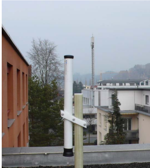
Bild 3.3: Langzeitmesssystem auf einem Gebäudedach in der Nähe einer Mobilfunksendeanlage
