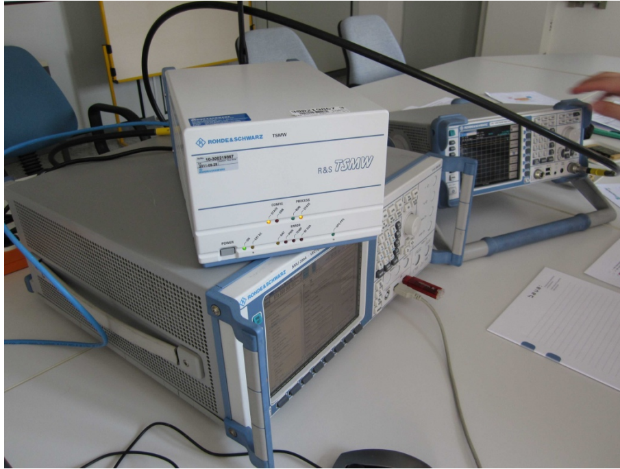
Bild 3.21: Messaufbau der Labormessungen zur Überprüfung der codeselektiven Messtechnik bei der Firma Rohde & Schwarz mit LTE-Frontend R&S TSMW
