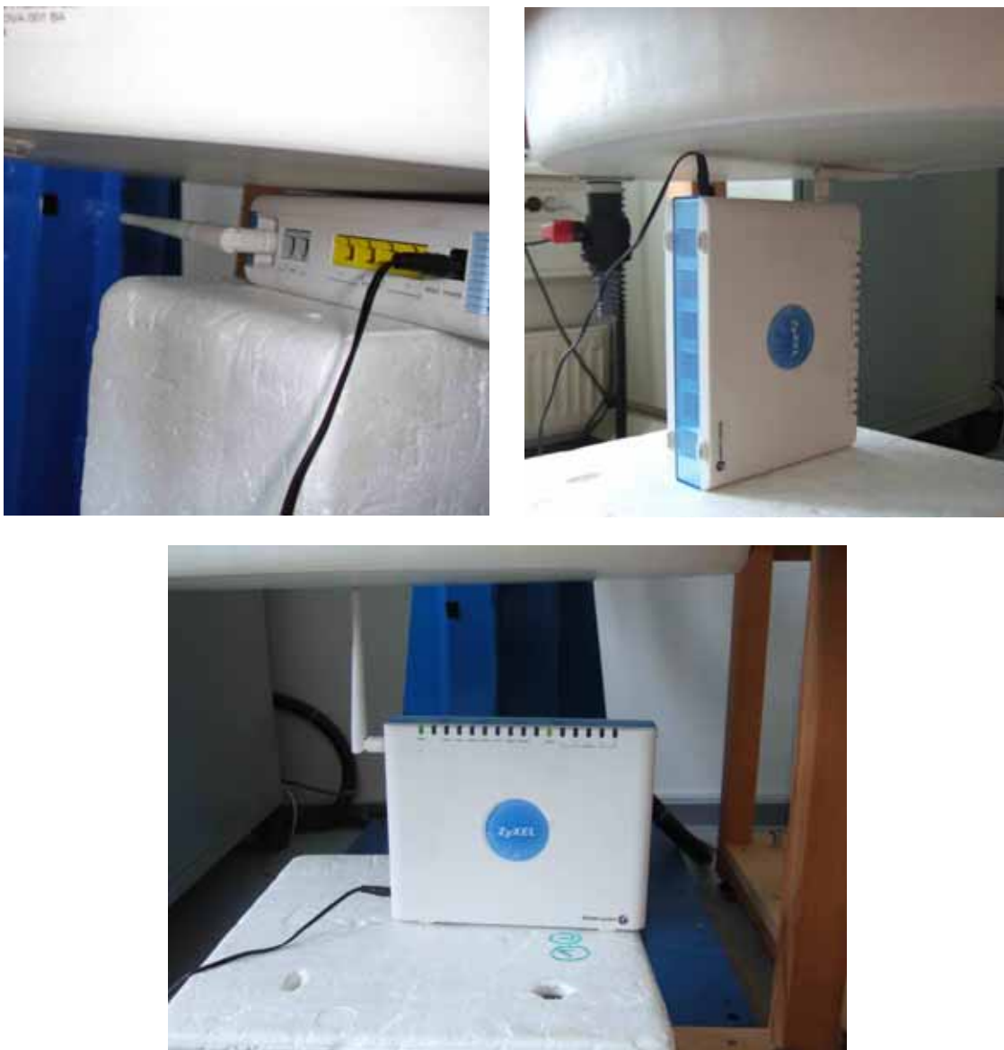
Bild 6.17: Positionierung des Endgerätes für die SAR-Messungen am Flachphantom: Position 1 (links oben), Position 2 (rechts oben) und Position 3 (unten)
