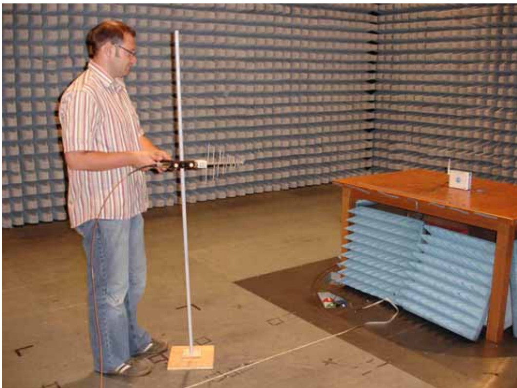
Bild 6.2: Messaufbau bei der Expositionsmessung unter Laborbedingungen
