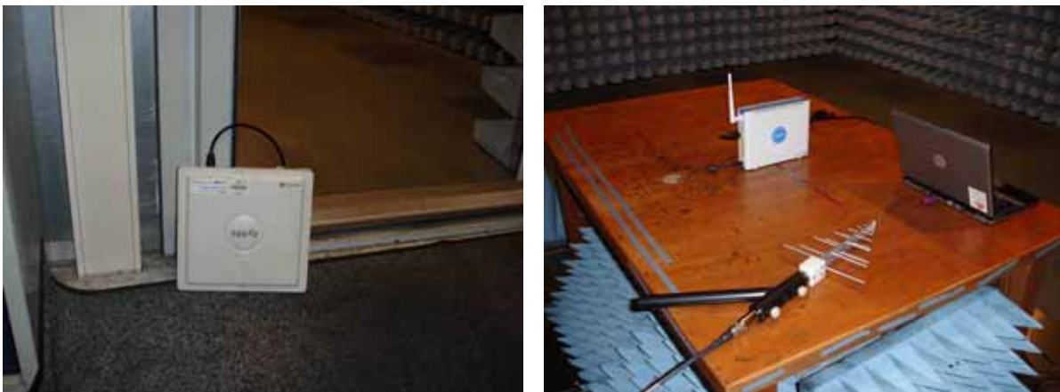
Bild 6.9: Positionierung der Außenantenne (links) und des Steuergerätes (rechts) bei den Messungen der Outdoor Unit Zyxel MAX-310 + MAX-3X0HW2
