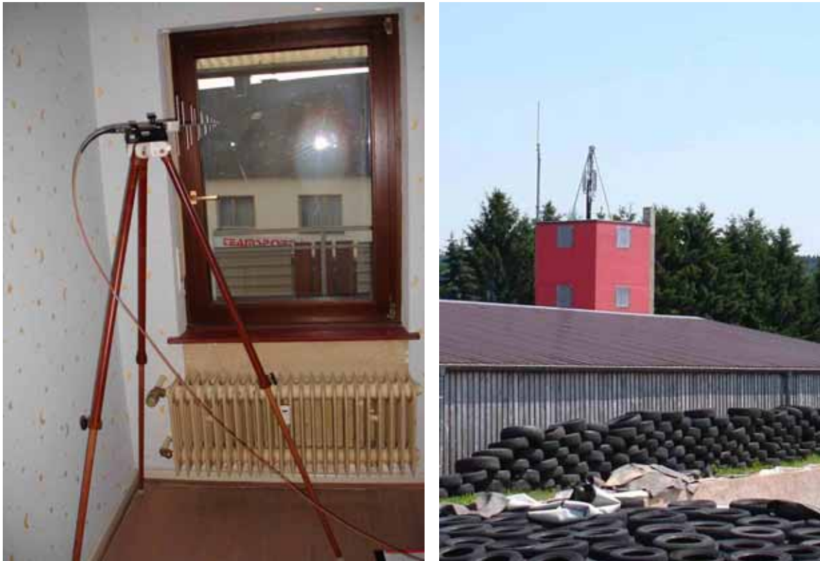
Bild 5.7: Messaufbau (links) und WiMAX-Anlage (rechts)
